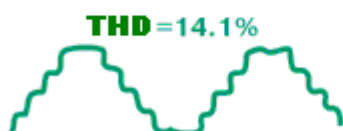
12-п.п. выпрямитель с улучшенным фильтром
